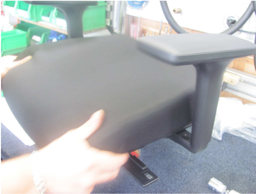
Unterschale mit Sitz verschrauben (Schrauben 7803500 5x14 VZ)
